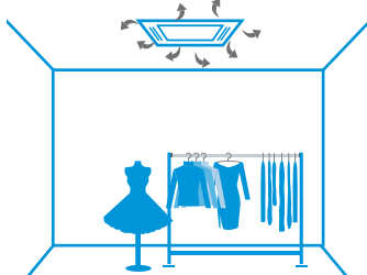
Distribuția aerului cu un filtru murdar
